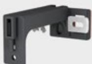
Der einklickbare Wandwinkel für die Einzelmontage ist hoch bruchfest, laststabil und schallschutzfördernd. Besonders einfach bei der Montage ist das werkzeuglose Einrasten in das Element. Per Flügelmutter in der Tiefe von 100-250 mm verstellbar. Die vertikal verschiebbare Befestigungsplatte ermöglicht es, die Bohrlöcher flexibel zu platzieren.
