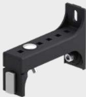
Speziell für die Montage von nextVIT Vorwandelementen an der C-Schiene des Ausbausystems haben wir diesen Wandwinkel entwickelt: dank EasyConnect Schnellverschlussystem kinderleicht befestigt und von 110 – 280 mm stufenlos in der Tiefe verstellbar.
